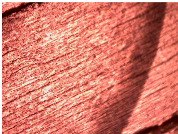
Obrázek 42: mikroskopie zdravého dřeva
