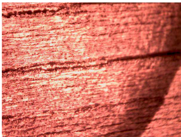
Obrázek 43: mikroskopie zdravého dřeva
